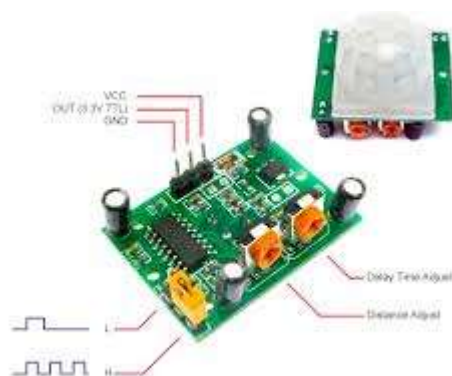
Рисунок 4.1 – Зовнішній вигляд датчика руху (присутності) HC-SR501
