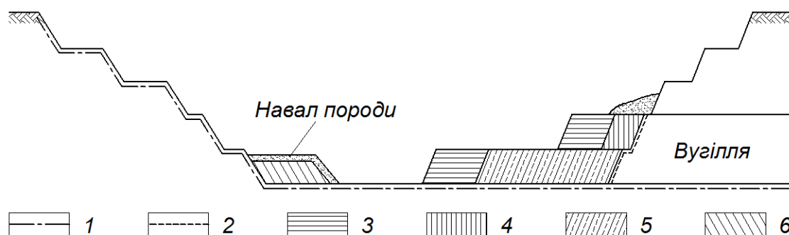
Рис. 27. Схематичне зображення ділянок, віднесених до різних категорій промислових запасів при відкритій розробці корисних копалин: 1 – технічна границя; 2 – контур розкритих запасів; 3 – готові до виїмки; 4 – підготовлені до зачистки; 5 – в тимчасових ціликах; 6 – тимчасово завалені
