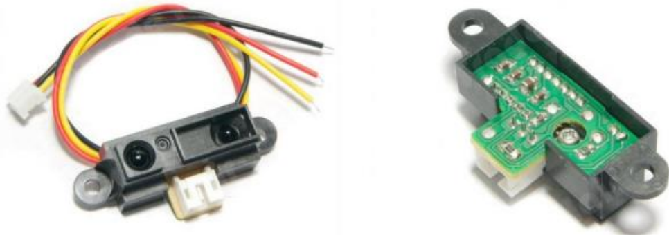
Рисунок 7.1 – Зовнішній вигляд інфрачервоного датчика відстані Sharp GP2Y0A21YK0F
