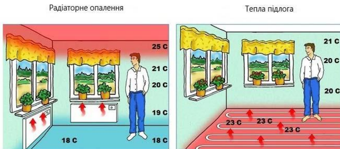
Рисунок - Порівняльні характеристики радіаторного опалення і теплої підлоги
