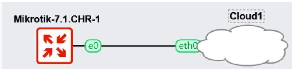
При правильному налаштуванні мережевих інтерфейсів GNS3 VM з’явиться можливість підключитись до віртуального роутера з операційної системи користувача. Для цього з сайту Mikrotik скачайте утиліту winbox для пошуку і підключення до обладнання Mikrotik <https://mikrotik.com/download>
