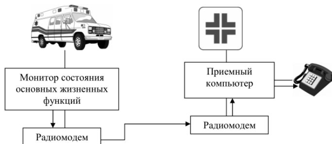
Рисунок 5.4. Общая схема системы передвижного мониторинга третьей группы
