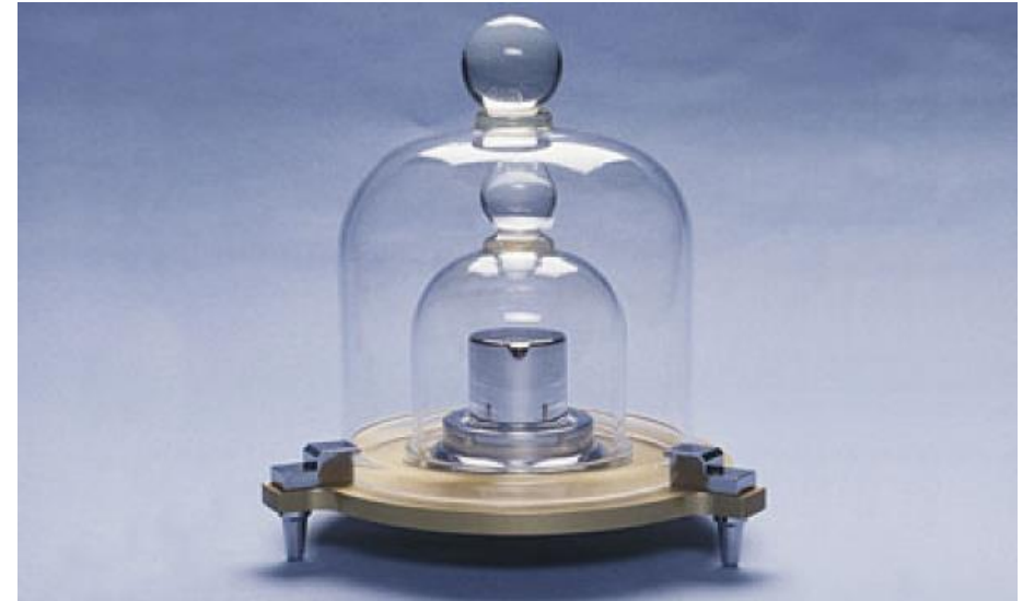
Рис.7.3. Міжнародний прототип кілограма, що зберігається в МБМВ
