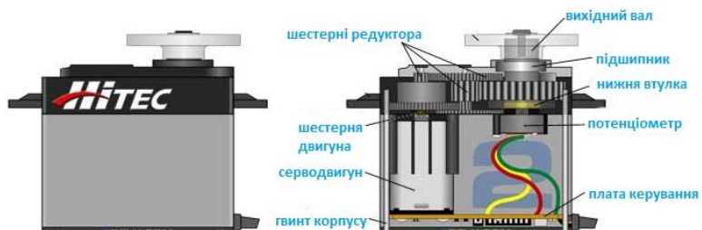
Рис. 2.5. – Внутрішня будова серводвигуна
