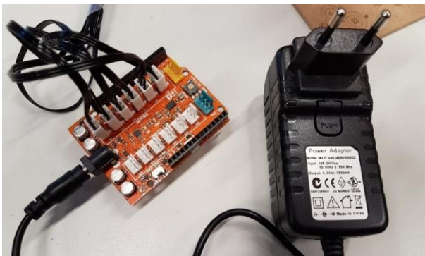
Рис. 2.8. – Модуль Braccio Shield та блок живлення модуля
