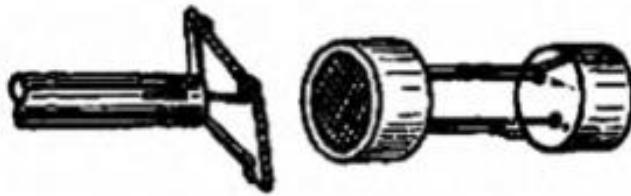
Рис. 2-51. Детали терапевтической трубки с охлаждением анода радиацией.
