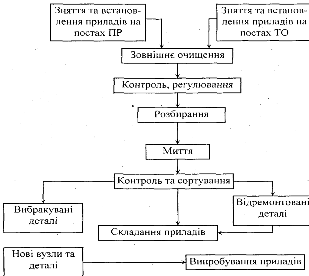
Рис. 3.25. Схема технологічного процесу ремонту паливної апаратури
