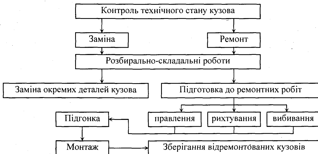
Рис. 3.48. Схема технологічного процесу у кузовній дільниці
