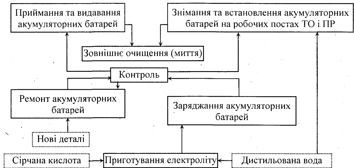
Рис. 3.22. Схема технологічного процесу відновлення працездатності акумуляторних батарей
