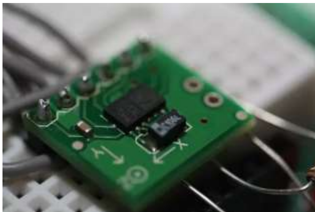
Рис.3.6. Типовий акселерометр для смартфона
