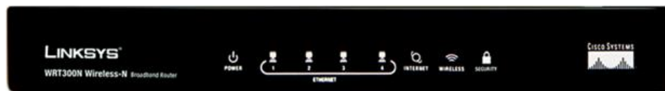
Рис. 3. Зовнішній вигляд передньої панелі маршрутизатора Linksys WRT300N
