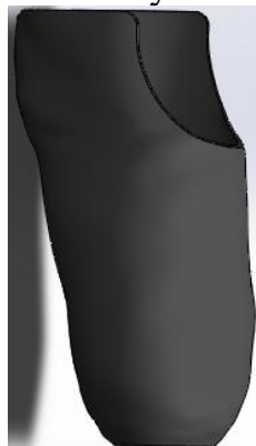
Рисунок 5 – Куксоприймач – гільза протезу
