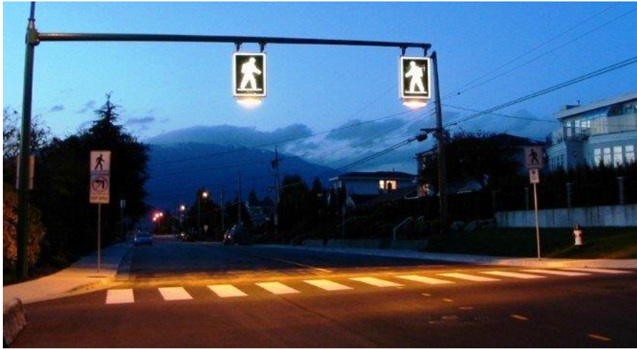
Рисунок 24 - Додаткове автономне освітлення зони нерегульованого пішохідного переходу в темну пору доби (джерело: https://odessa-life.od.ua )
