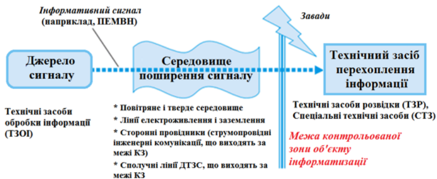
Рис. 1.25 Схема технічного каналу витоку інформації в ТЗОІ
