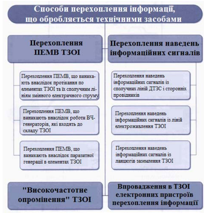
Рис. 1.44 Способи перехоплення інформації в ТЗОІ
