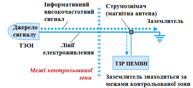
Рис. 1.36 Схема технічного каналу витоку інформації, що виникає за рахунок наведень інформативних сигналів в ланцюгах заземлення ТЗОІ
