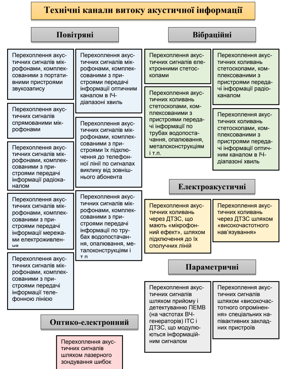
Рис. 1.23 Класифікація технічних каналів витоку акустичної інформації У вібраційних (структурних) технічних каналах витоку інформації середовищем поширення акустичних сигналів є конструкції будівель, споруд
