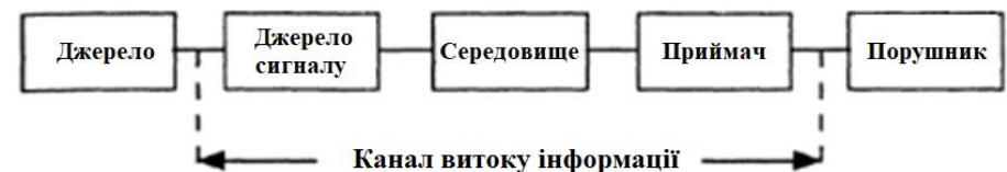
1.5 Модель технічного каналу витоку інформації
