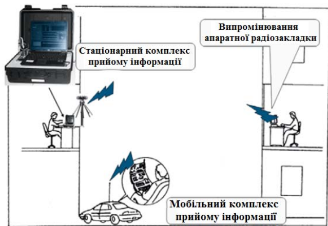
Рис. 1.39 Приклад перехоплення інформації, оброблюваної ТЗОІ, шляхом установки в них закладних пристроїв
