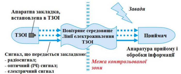
Рис. 1.40 Схема технічного каналу витоку інформації, що створюється шляхом впровадження у ТЗОІ закладних пристроїв
