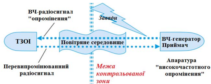
Рис. 1.38 Схема технічного каналу витoku інформації, створюваного шляхом «високочастотного опромінення» ТЗОІ
