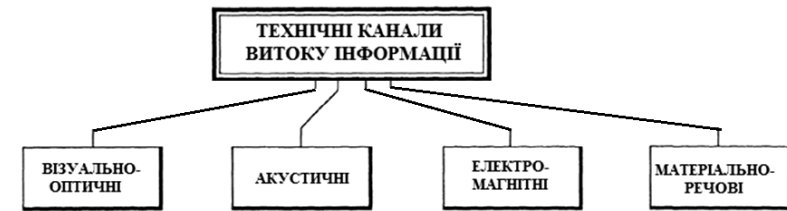
Рис. 1.19 Класифікація технічних каналів витоку інформації
