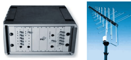
Рис. 1.29 Комплекс перехоплення ПЕМВ ТЗОІ
