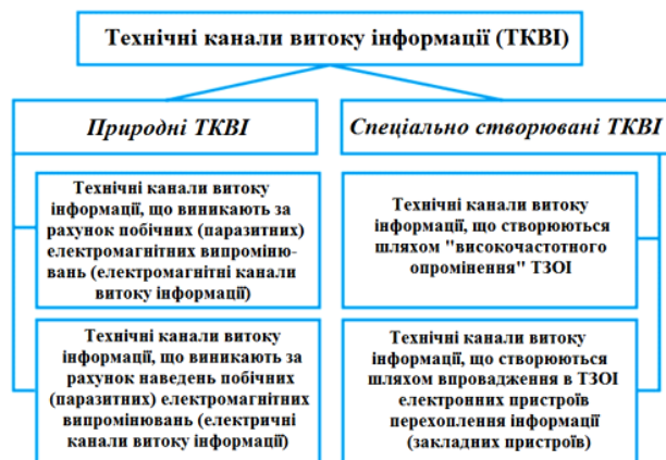
Рис. 1.26 Класифікація технічних каналів витоку інформації в ІТС
