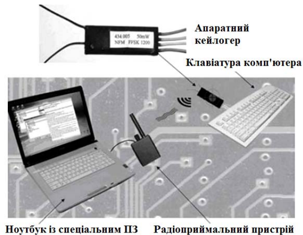
Рис. 1.42 Приклад застосування апаратного кейлогера
