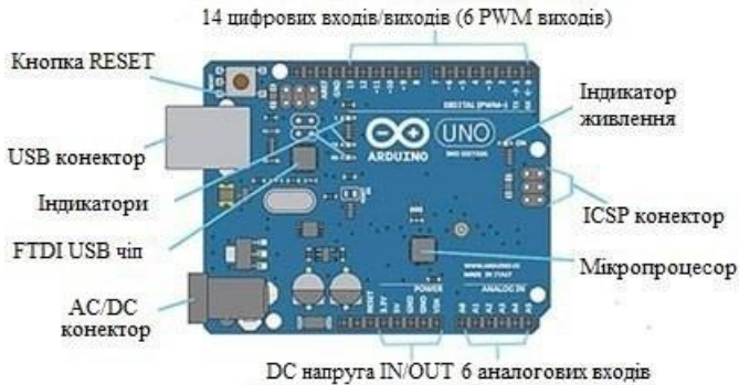
Рис. 2.10. – Контролер Arduino Uno
