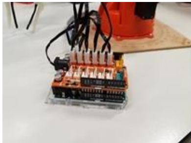
Рис. 2.6. – Загальний вигляд мікроконтролера Arduino Uno та модуля Braccio Shield (а), під'єднання модуля Braccio Shield до Arduino Uno (б), з'єднані модуль Braccio Shield та Arduino Uno (в)
