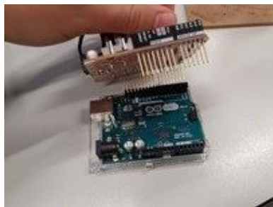
Рис. 2.6. – Загальний вигляд мікроконтролера Arduino Uno та модуля Braccio Shield (а), під'єднання модуля Braccio Shield до Arduino Uno (б), з'єднані модуль Braccio Shield та Arduino Uno (в)
