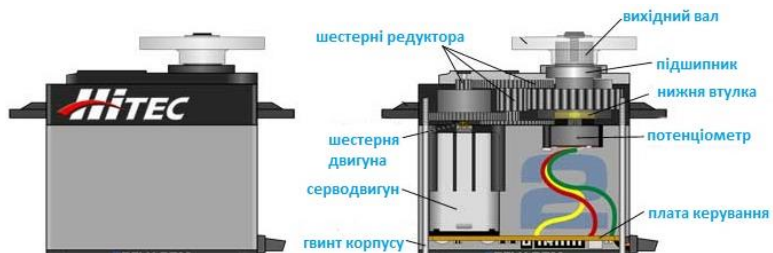
Рис. 2.5. – Внутрішня будова серводвигуна
