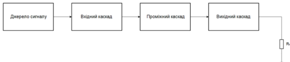
Рис. 6.1. Структурна схема вимірювального підсилювача
