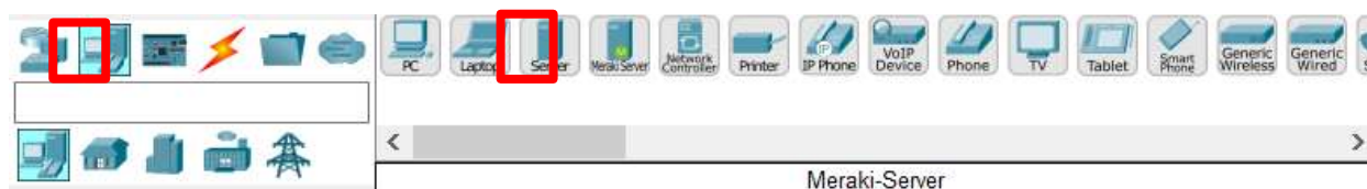
Рисунок 2 – Сервер в панелі пристроїв
