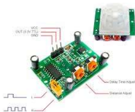
Рисунок 10.1 – Зовнішній вигляд датчика руху (присутності) HC-SR501
