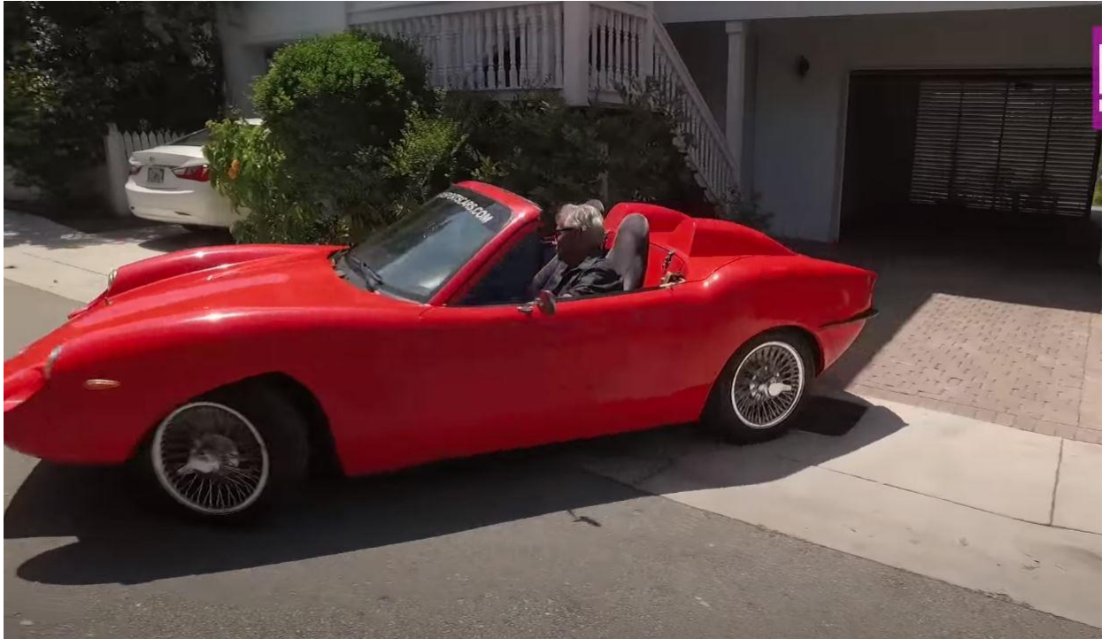
Рис. 8.3. Автомобіль, що виготовлений з конопляного пластику [4]
