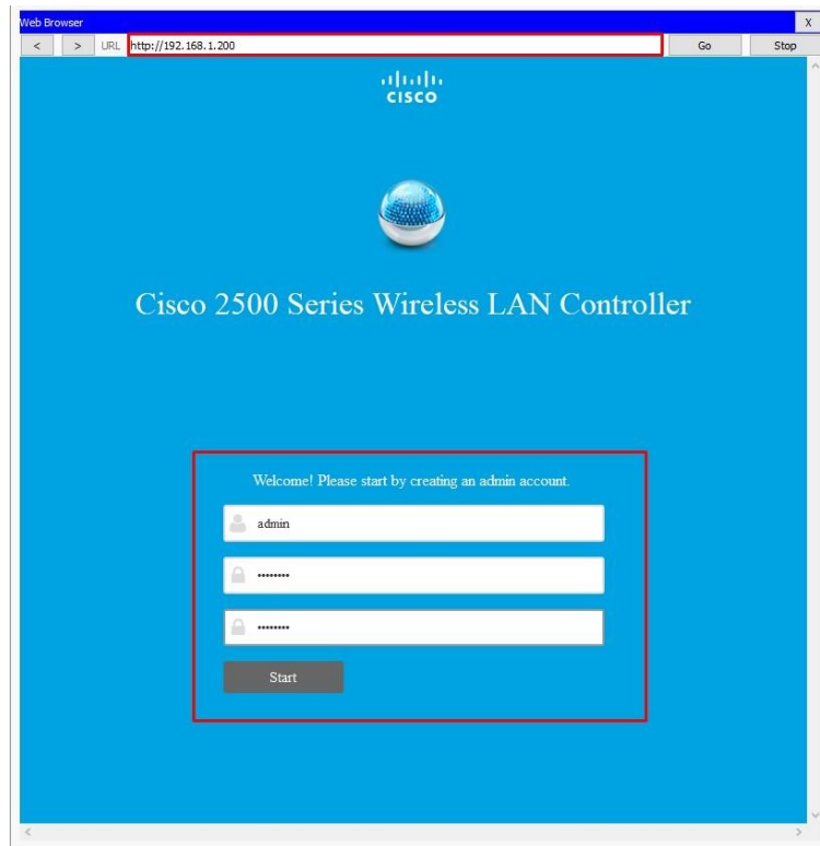
Рисунок 11 – Початкові налаштування Wireless Lan Controller
