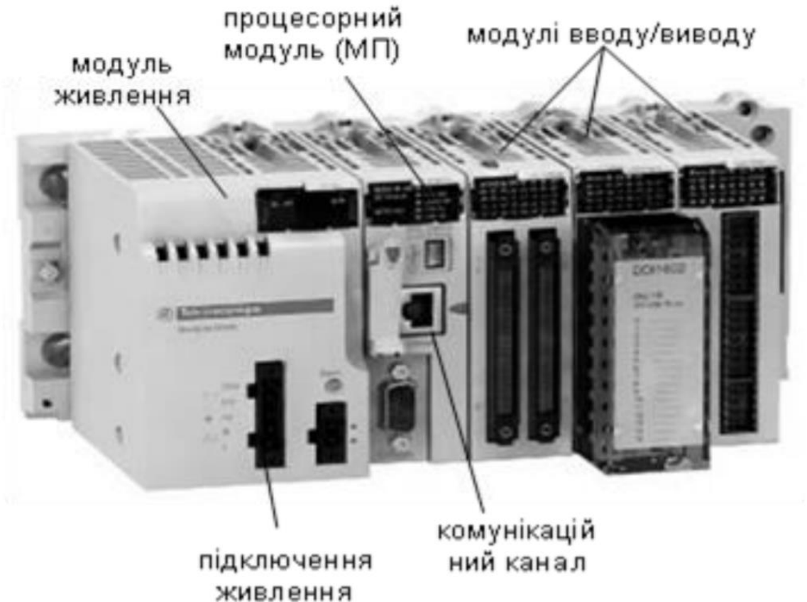
Рис. 1.4. Приклад ПЛК модульного типу
