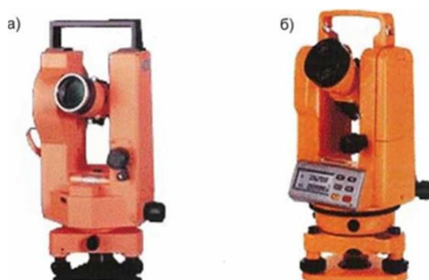
Рисунок 3.51 — Теодоліти: а – оптичний теодоліт ОМЗ ЗТ2КП; б – електронний цифровий теодоліт Geo-Fennel FET 120
