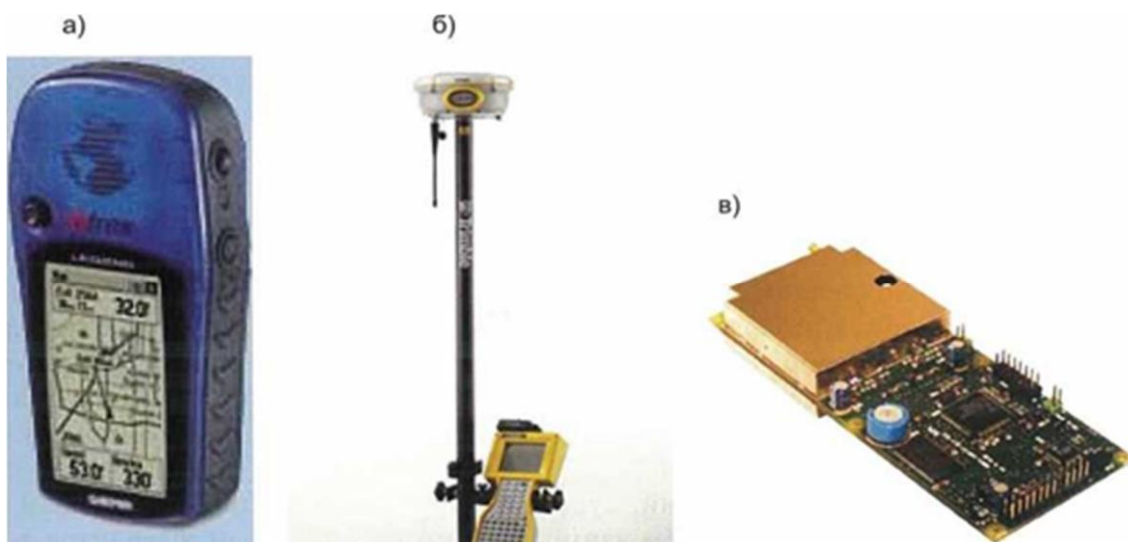
Рисунок 3.59 – Сучасні приймачі : а – навігаційний GPS-приймач Garmin Etrex Legend; б – геодезичний GPS-приймач Trimble R8; в – комбінований приймач GPS / ГЛОНАСС
