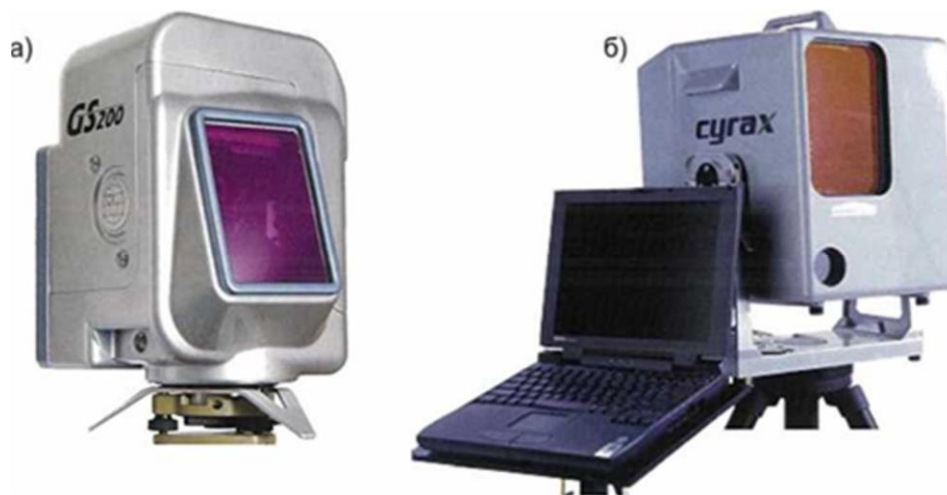
Рисунок 3.53 — Лазерні сканери: а – MENSIS GS200; б – Leica CYRAX 2500 У наступних розділах буде розглянуто, використання цих приладів під час знімання розташування просторових об'єктів на місцевості.
