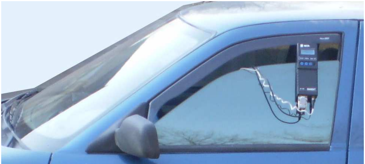
Рис. 2.10. Установлення на бічне скло автомобіля електронного блоку приладу «Ефект»
