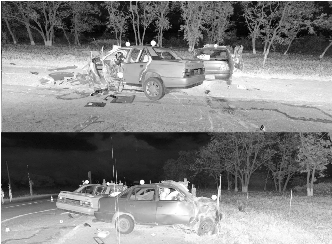
Рис. 6.3. Зображення місця ДТП, що отримані після лазерного сканування з різних ракурсів
