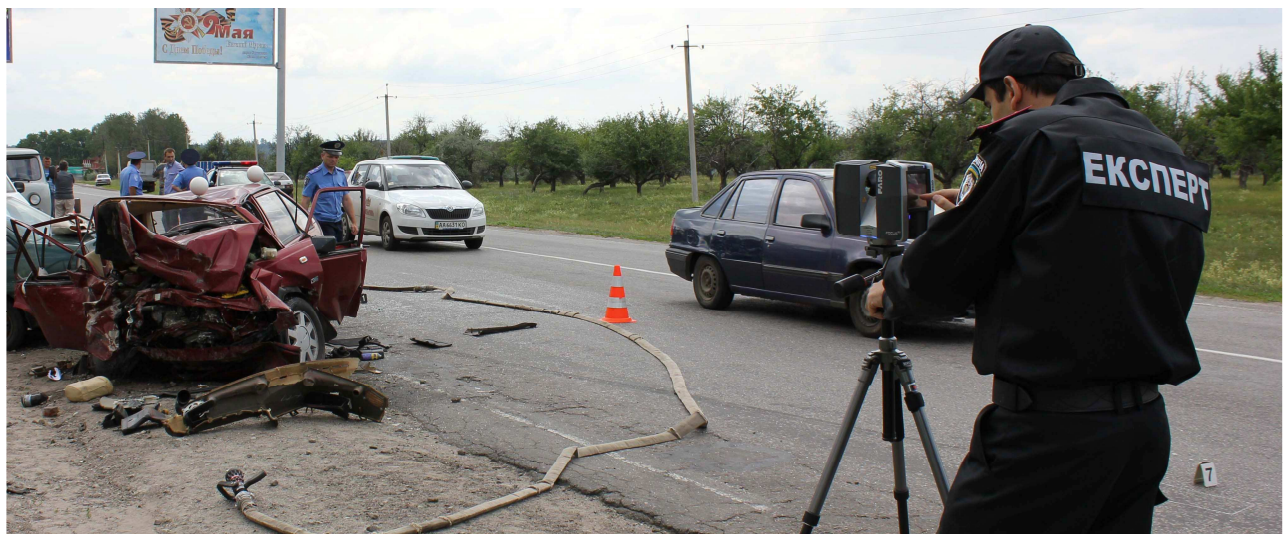
Рис. 6.2. Лазерне сканування ділянки дороги експертом-автотехніком під час огляду місця ДТП
