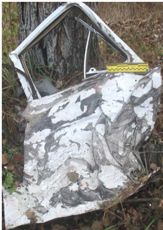
Рис. н.6. Деформація правої передньої двері ГАЗ-2410
