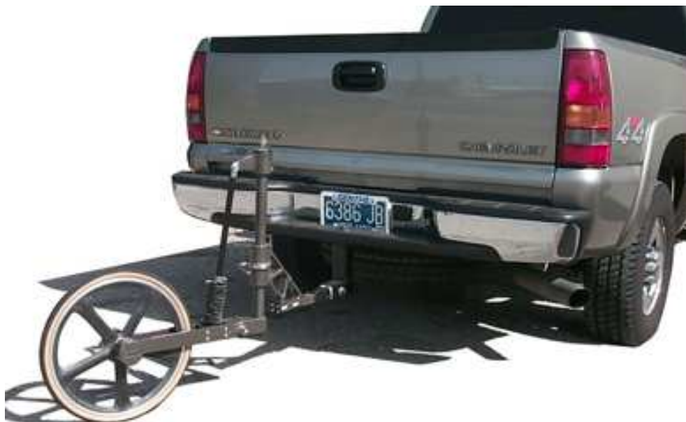
Рис. 2.7. Приклад встановлення приладу «п'яте колесо» на ТЗ
