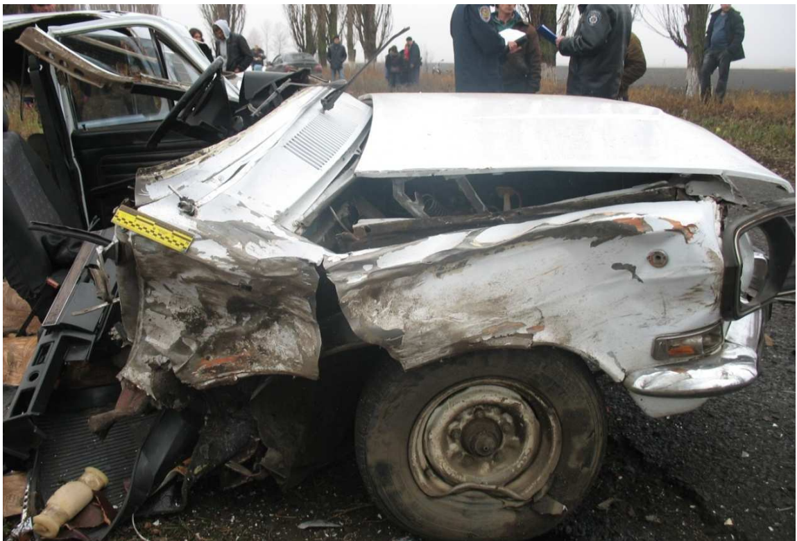
Рис. н.5. Деформація переднього правого крила ГАЗ-2410
