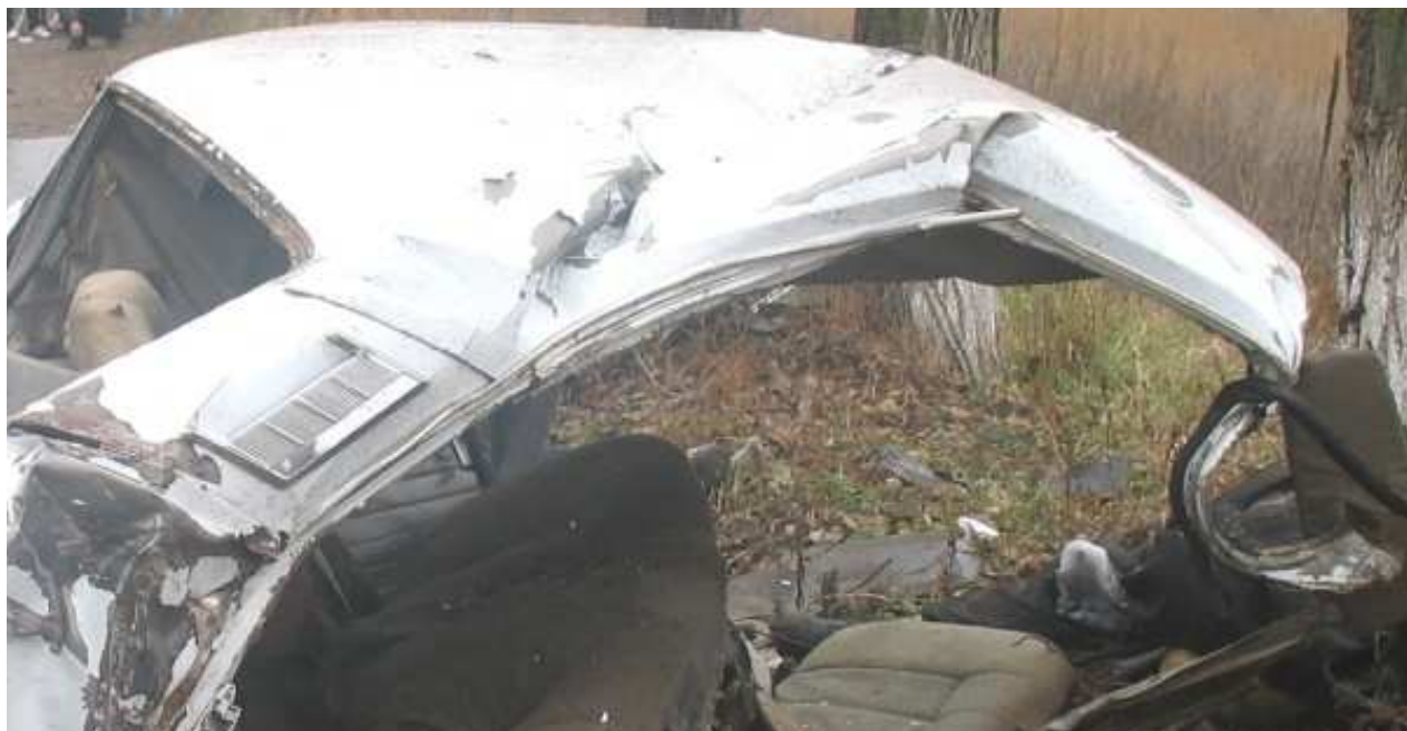
Рис. н.7. Деформація передньої стійки правої боковини й даху ГАЗ-2410
