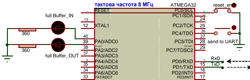
Рис. 4.8. Схема підключення МК для реалізації кільцевих буферів
