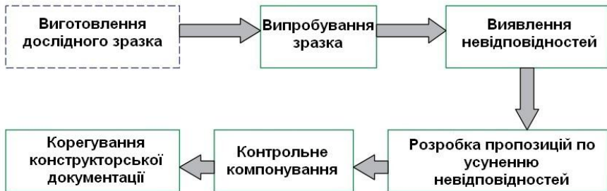
Рисунок 1.20 - Схема циклу усунення невідповідностей конструкції
