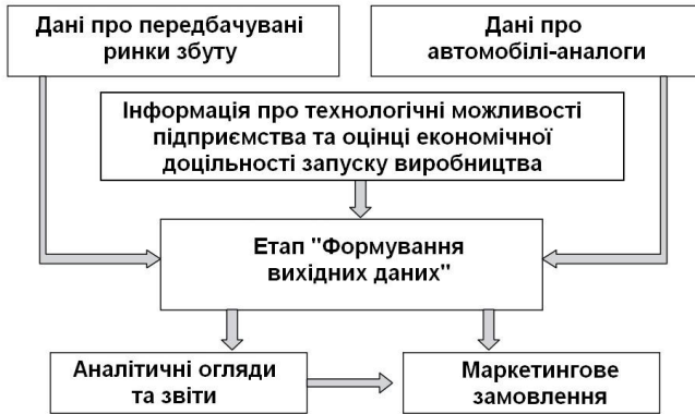
Рисунок 1.2 - Схема етапу «Формування вихідних даних»
