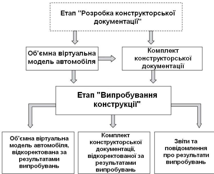
Рисунок 1.19 - Схема етапу «Випробування конструкції»
