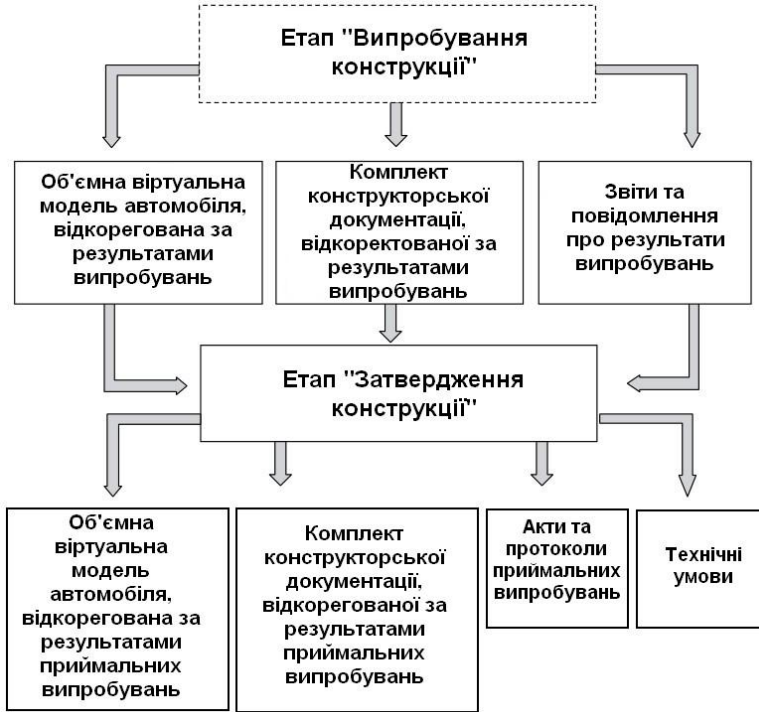
Рисунок 1.21 - Схема етапу «Затвердження конструкції»
