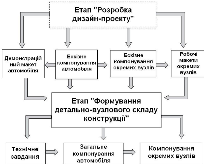
Рисунок 1.14 - Схема етапу «Формування детально-вузлового складу конструкції»
