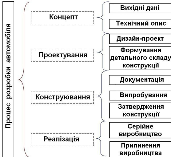
Рисунок 1.1 - Схема процесу розробки легкового автомобіля
