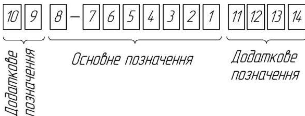
Рисунок 15.6 – Основні та додаткові позначення підшипників кочення
