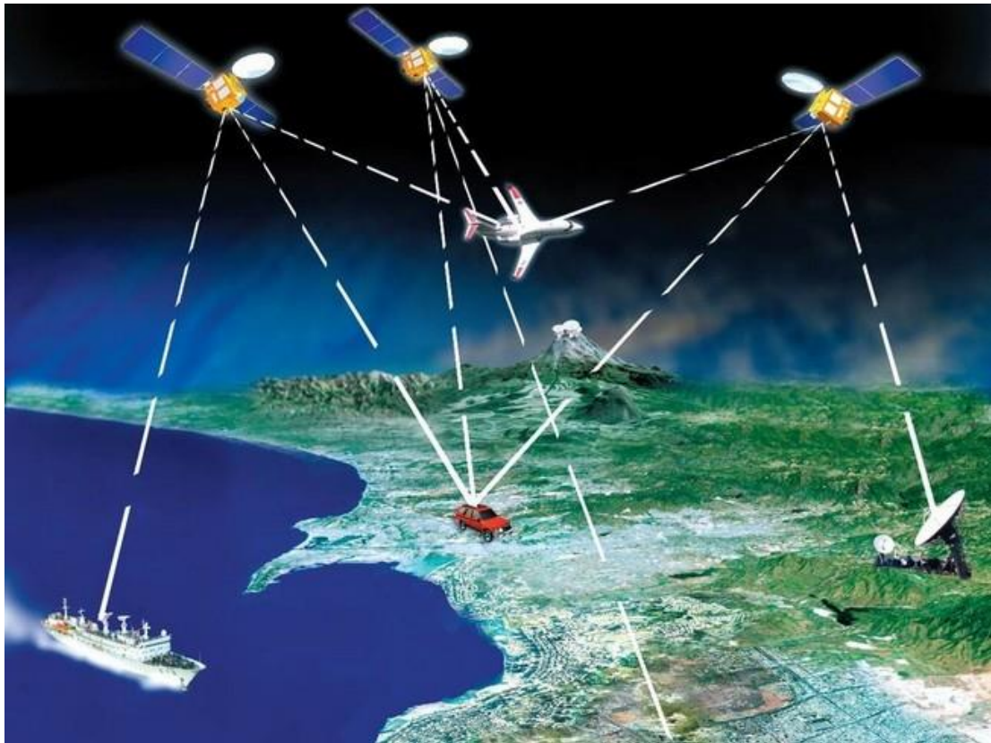
Рисунок 1.4 – Для точного позиціонування потрібно мінімум три супутники і земну кулю (або четвертий супутник)
