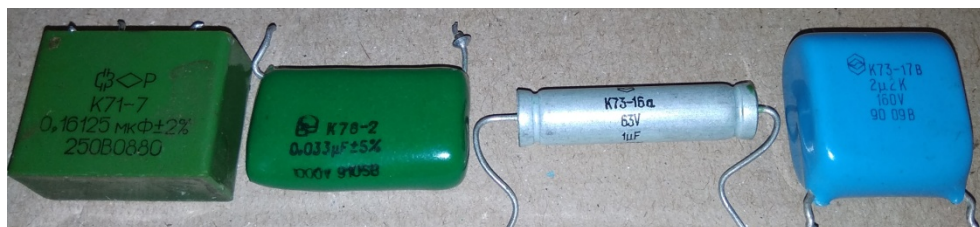
Рисунок 2.5 – Маркування на корпусі постійного конденсатора
