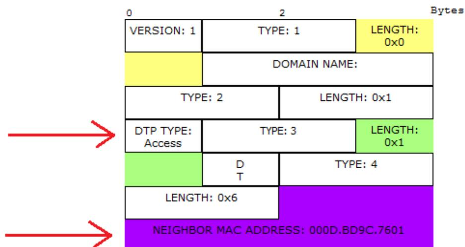
Відкриваю та бачу, що це DTP інкапсульований у Ethernet-кадр. Відправляю він його на мультикастовий адресу "0100.0ccc.cccc", який відноситься до протоколів DTP, VTP, CDP. І зверну увагу на 2 поля у заголовку DTP.
