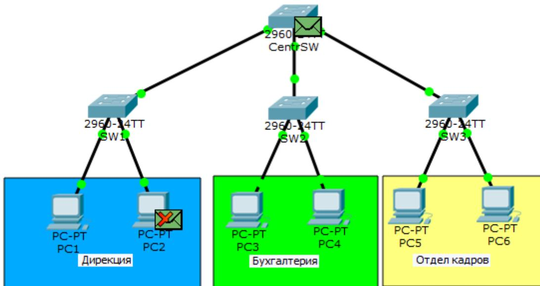
Після тега він відправляє кадр на PC2 (оскільки він у тому ж VLAN) і на центральний комутатор по транковому порту.
