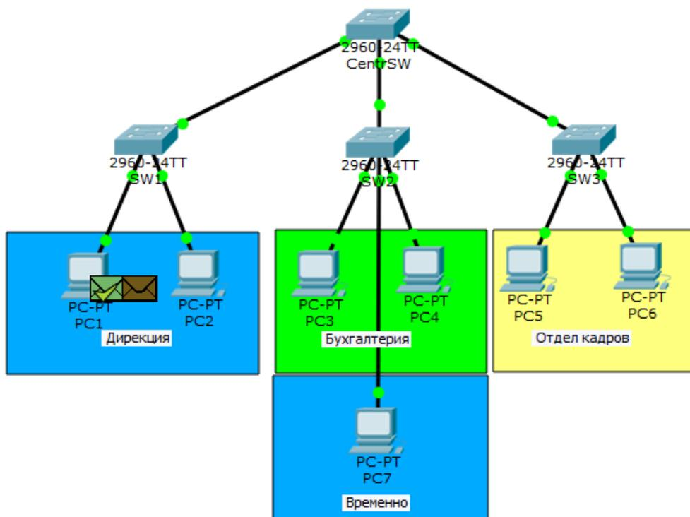
ARP доходить до PC1, що свідчить галочка на конверті. Тепер йому відома MAC-адреса і вона пускає в хід ICMP.
