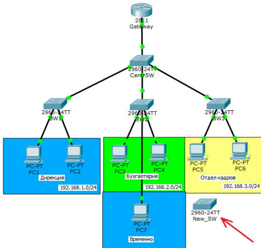
Тепер зайду в налаштування нового комутатора і жорстко пропишу роботу в режимі trunk.
