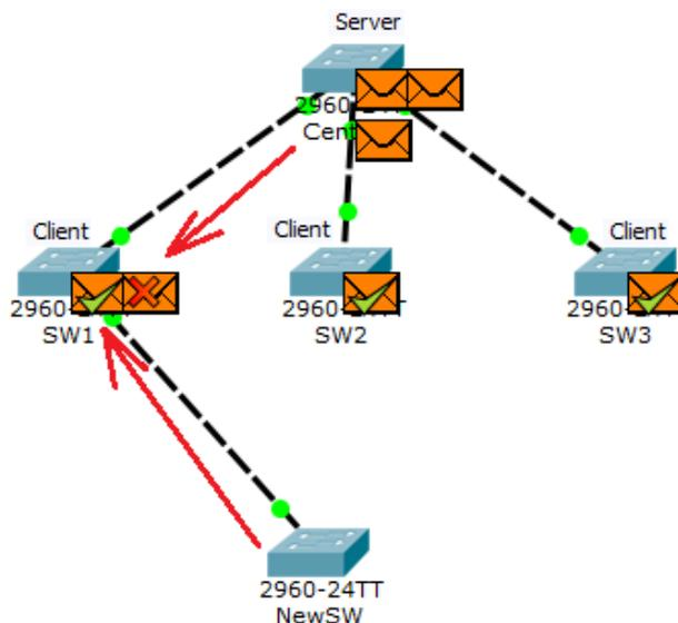
Зауважте, що на SW1 приходять одразу 2 VTP-повідомлення (від NewSW та від CentrSW). У повідомленні від NewSW він бачить, що номер ревізії вищий, ніж його синхронізує свою базу. А ось повідомлення від CentrSW для нього вже застаріло і він відкидає його.
