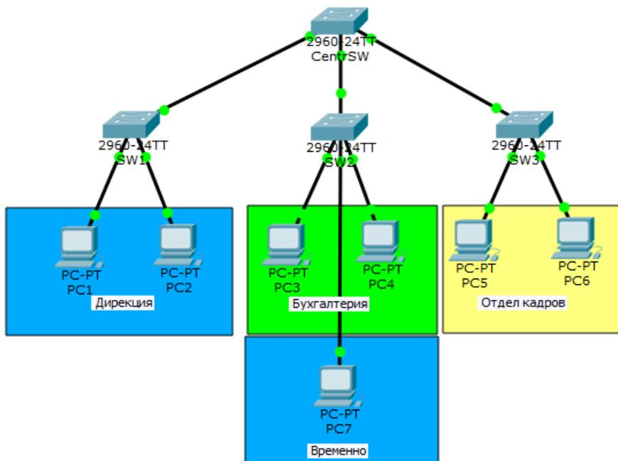
Підключили комп'ютер к порту FastEthernet 0/3 коммутатора и присвою IP-адрес 192.168.1.8/24. Теперь настрою коммутатор **SW2**. Так как компьютер должен находиться во 2-ом VLAN, о котором коммутатор не знает, то создам его на коммутаторе.
