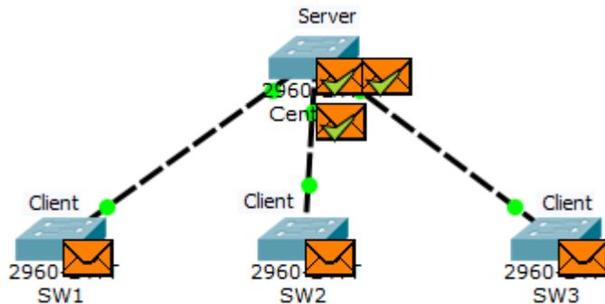
Отак у принципі працює протокол VTP. Але він має дуже великі мінуси. І мінуси ці щодо безпеки. Поясню з прикладу. У нас є центральний комутатор, на якому створюються VLAN, а потім за мультикастом він їх синхронізує з усіма комутаторами. У нашому випадку він розповідає про VLAN 20. Пропоную ще раз глянути на його конфігурацію.
