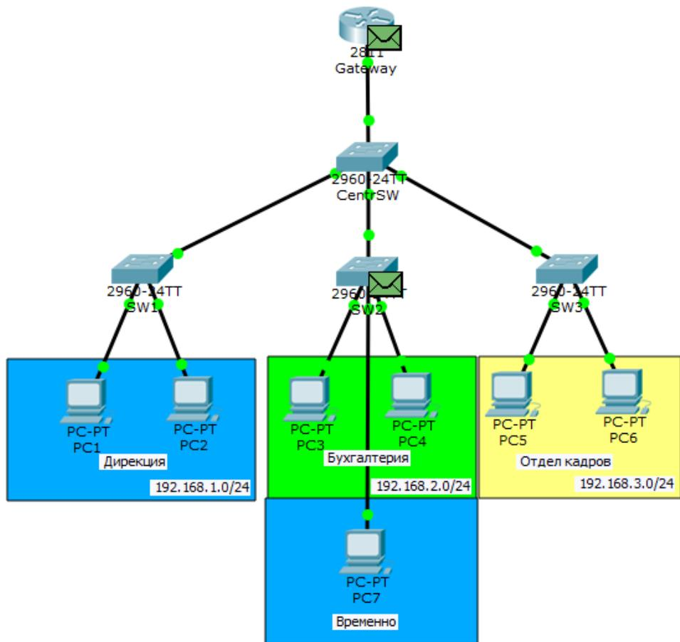
**Зверніть увагу.** Як тільки кадр прибуває на CentrSW, комутатор не розсилає його будь-кому. Він розсилає лише на ті порти, де дозволено пропуск 2-го VLAN. Тобто на маршрутизатор і на SW2 (там є користувач, що сидить у другому VLAN).
