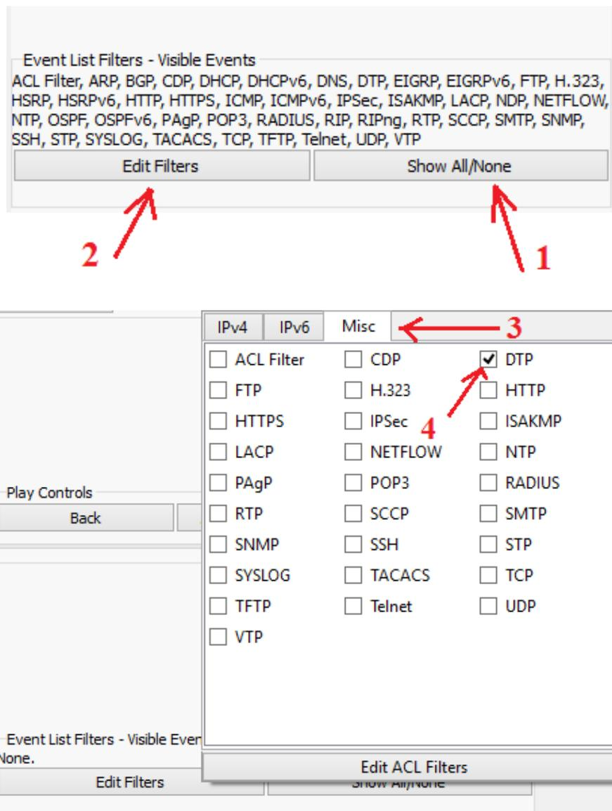
Думаю, тут все зрозуміло. З'єдную комутатор кабелем і, при піднятті лінків, один з комутаторів генерує DTP-повідомлення.
