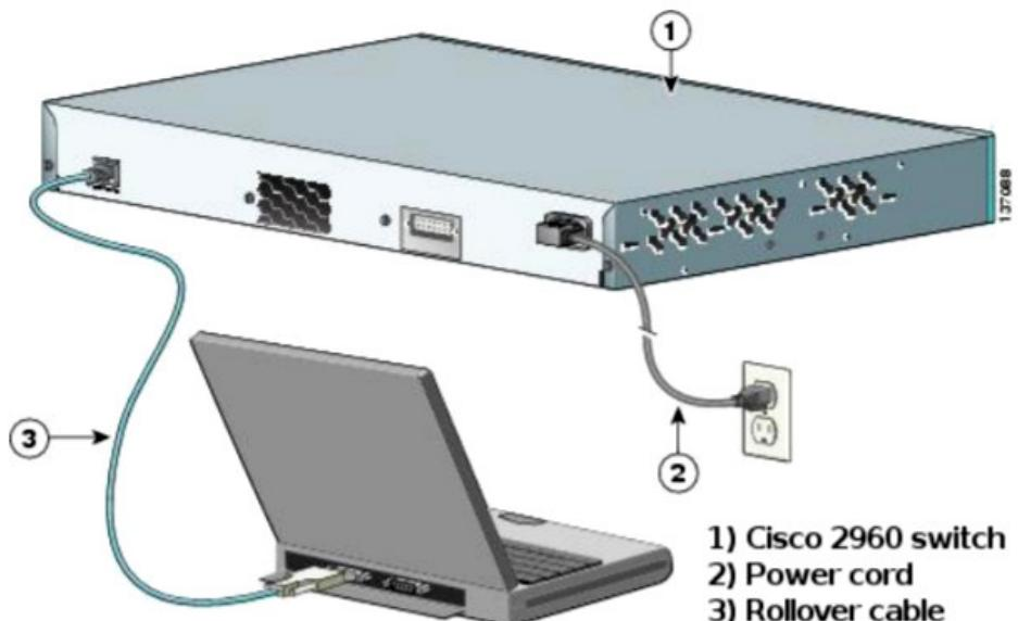
**Примітка:** На більшості комп'ютерів послідовні СОМ-порти наразі відсутні. Для консольного з'єднання між комп'ютером та пристроєм Cisco можна використовувати адаптер USB-DB9 разом з консольним кабелем. Такі адаптери можна придбати в будь-якому роздрібному магазині електроніки.
