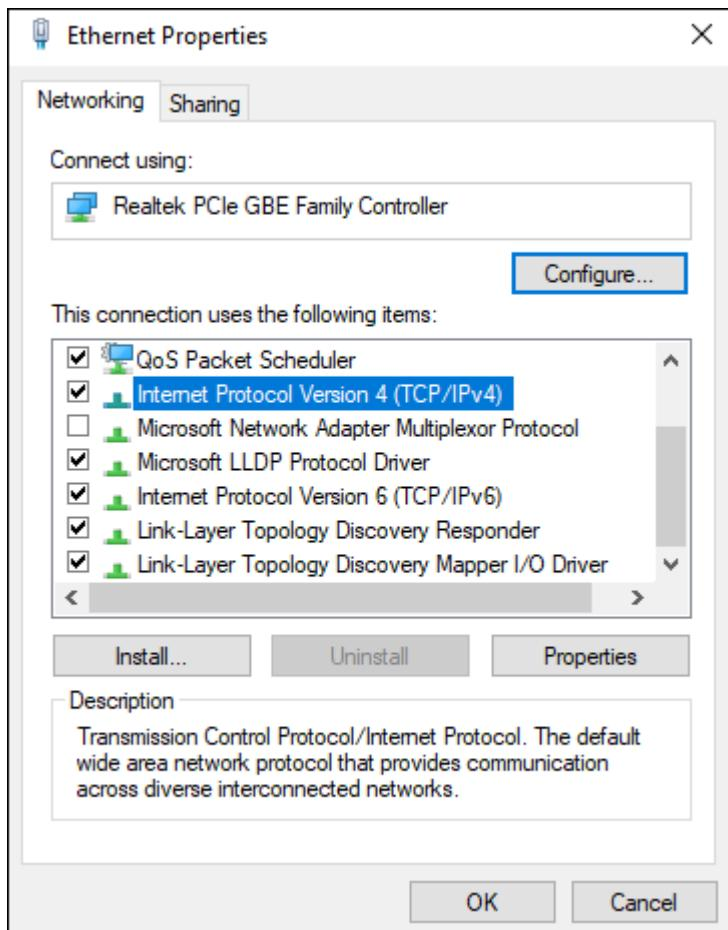
Виділіть **Internet Protocol Version 4 (TCP/IPv4)** та натисніть **Properties**, щоб відкрити **Internet Protocol Version 4 (TCP/IPv4) Properties** вікно, яке відображено на рисунку. Налаштуйте адресу IPv4, маску підмережі та параметри шлюзу за замовчуванням на PC-A.
