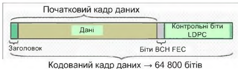
Рисунок 1 – Структура інформаційного кадру після завадостійкого кодування
