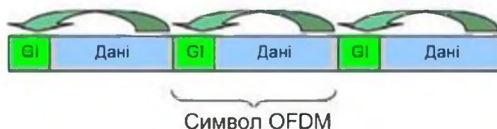
Рисунок 2 – Захисні інтервали в структурі OFDM сигналу
