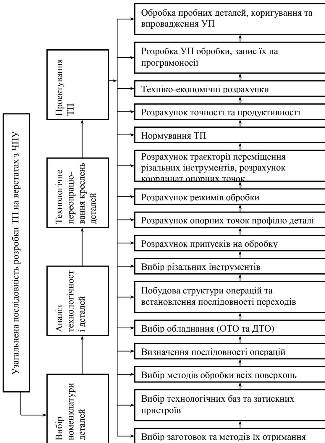
Рис. 8.1. Узагальнена схема послідовності робіт при розробці ТП на верстаті з ЧПУ
