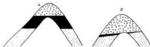
Рис. 8.3. Умови залягання газу, нафти і води в пастці а – поклад нафти з газовою шапкою; б – поклад газу з нафтовою облямівкою
