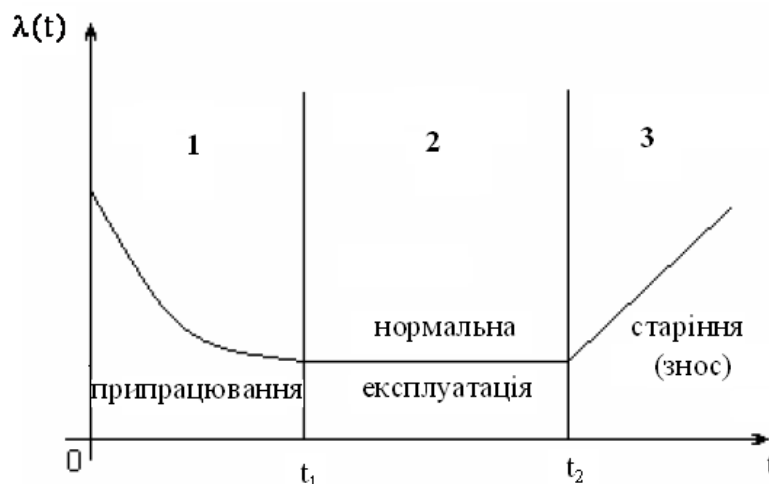
Рисунок 2.1 – Залежність інтенсивності відмов від часу роботи ТЗ
