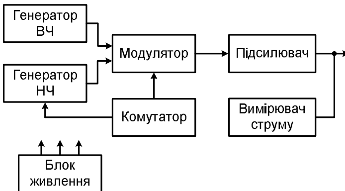
Рисунок 2.1 – Структурна схема апарата «Амплипульс-4»
