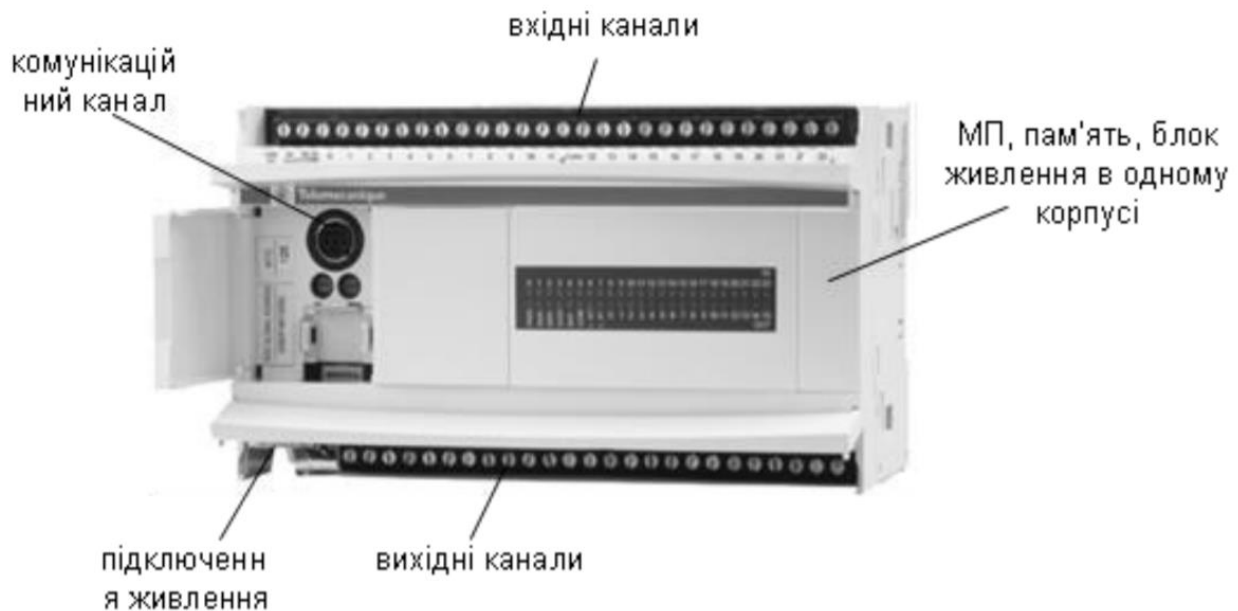
Рис. 1.2. Приклад ПЛК у моноблочному виконанні
