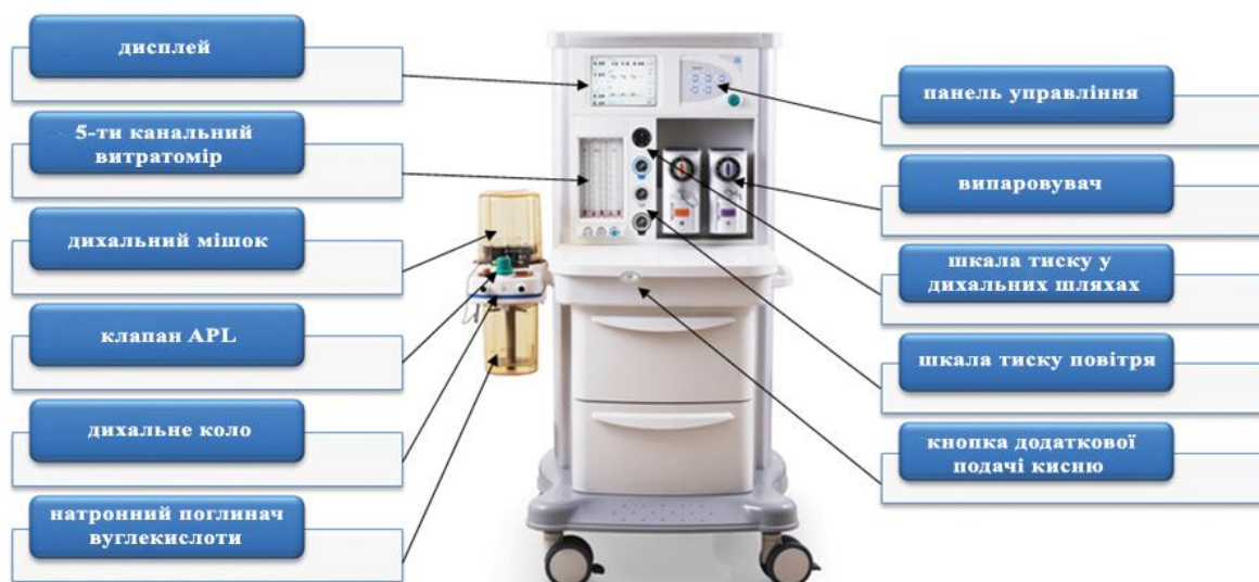
Схема будови наркозного апарату
