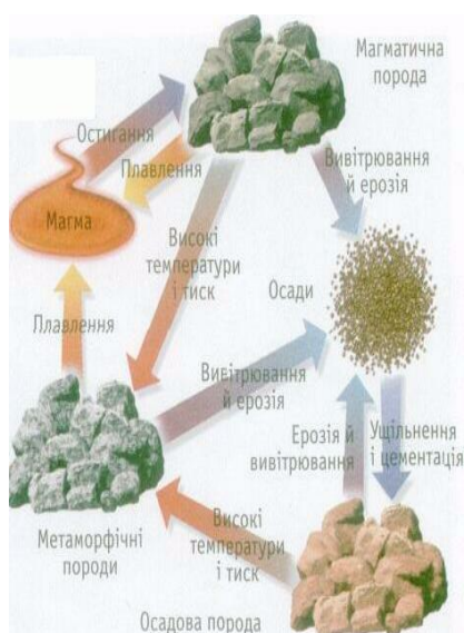
Рис. 5. Схема процесів, що відбуваються при переробці та переході порід з одного типу в інший
