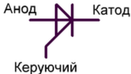
Несиметричний незакриваючий тріодний тиристор (триністор) з керуванням за анодом
