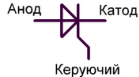
Несиметричний незакриваючий тріодний тиристор (триністор) з керуванням за катодом
