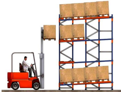
Рис.7.8. Схема палетного стелажу Push Back
