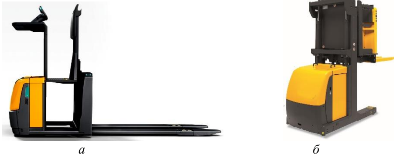
Рис. 7.18. Комплектувальник замовлень: а – низькорівневий; б – високорівневий
