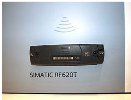
Рис.1. RFID-мітка SIMATIC RF620T, що відповідає стандартам ISO 18000-6C EPC CLASS 1 GEN. По центру задано штрих-код, праворуч - Data Matrix
