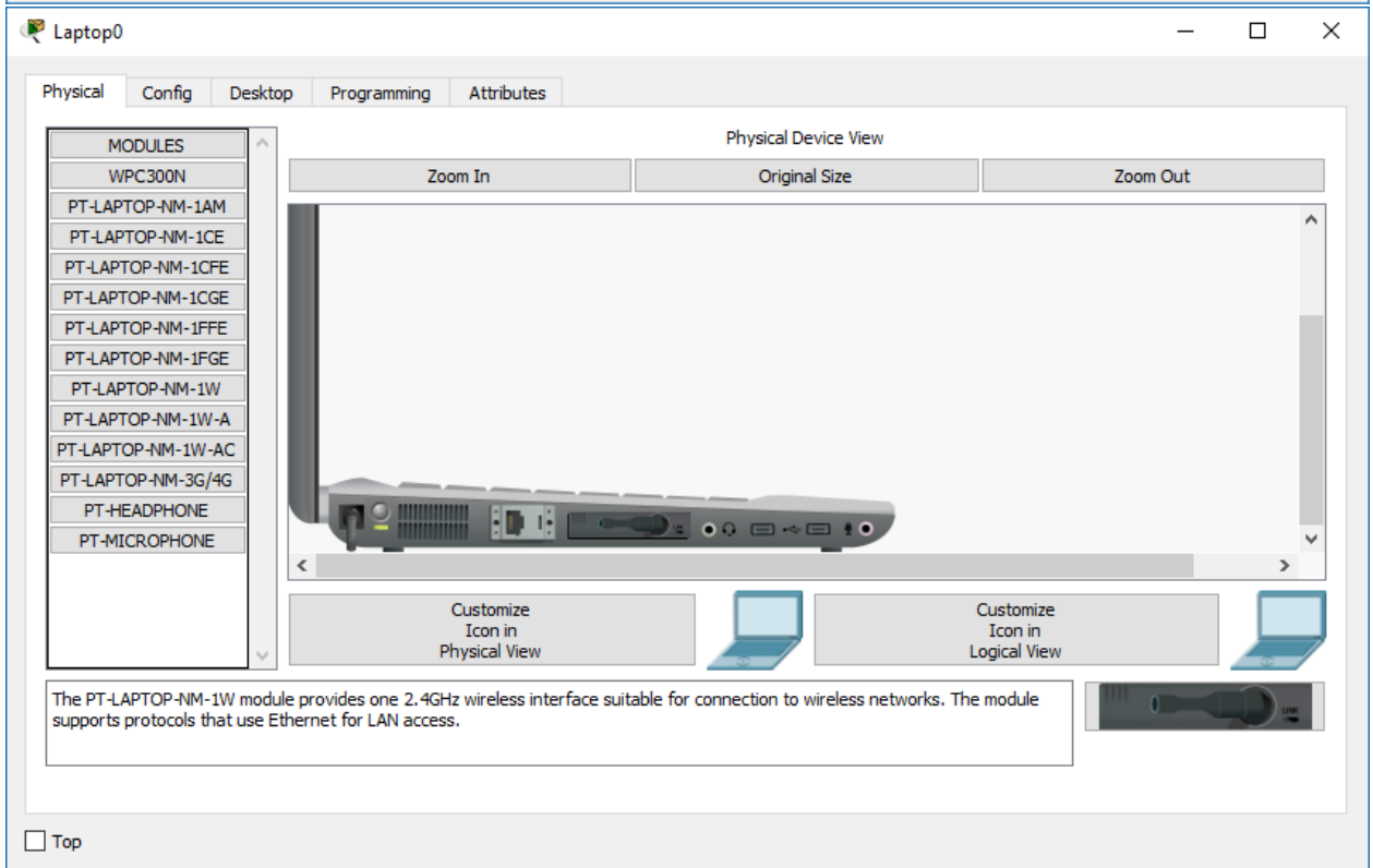
Рисунок 9 - 12 – Заміна адаптеру Fast Ethernet на Wireless Після встановлення бездротового адаптеру на ноутбуці, введемо SSID нашого Home Gateway в налаштуваннях (рис. 13).
