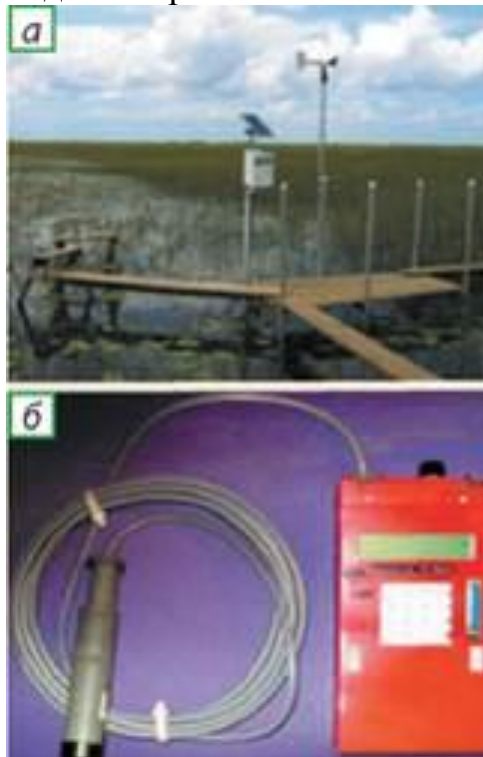
Рис. 5.1. Гідрологічний пост (а) і сучасний прилад – електронний водомірний пост (б) для визначення показників водного стоку
