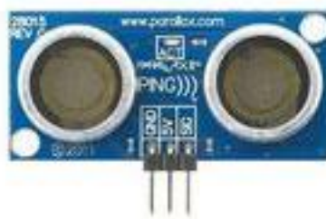
Рисунок 7.1 – Зовнішній вигляд ультразвукового датчика відстані
