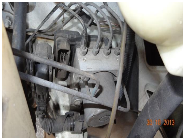
Антиблокувальна система (АБС) автобуса у неробочому стані 2 - загинуло, 16 - травми
