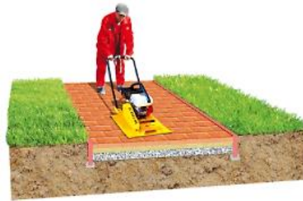
Рис.26. Процес ущільнення поверхні
