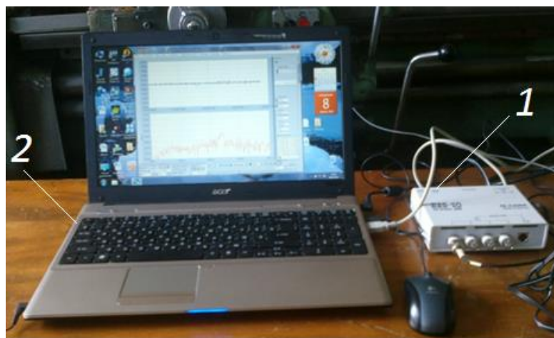
Рис. 5.3. Дослідна установка для запису вібраційного сигналу. 1 – вимірювальна система для віброакустичних досліджень E20-10 виробництва L-CARD. 2 – ПЕОМ з спеціалізованим програмним забезпеченням LGraph.
