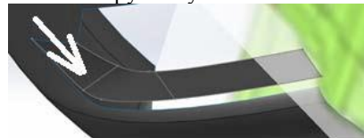
Рисунок 14.85 - Використання інструменту «Поверхность границы»
