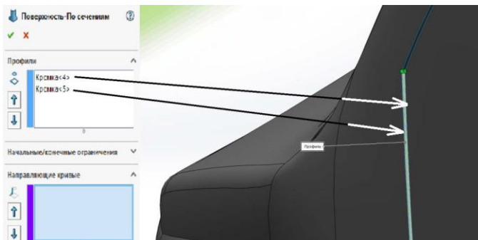
Рисунок 14.112 - Заповнення порожнечі після зсуву скла і накладок
