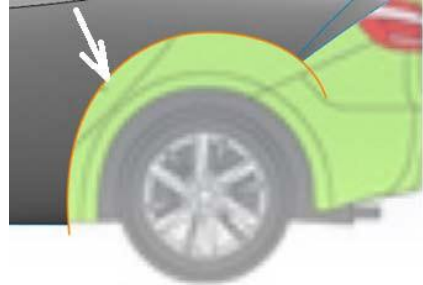
Рисунок 14.79 - Використання інструменту «Отсечь поверхность»
