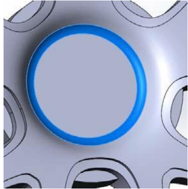
Рисунок 14.162 - Округлення в центрі диска
