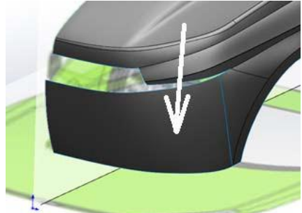
Рисунок 14.60 - Використовуємо інструменти «Поверхність границь» і «Сшити»
