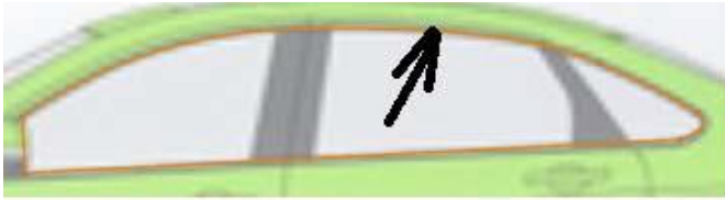
Рисунок 14.107 - Створюємо «Эскиз» і вибираємо поверхню зони вікон
