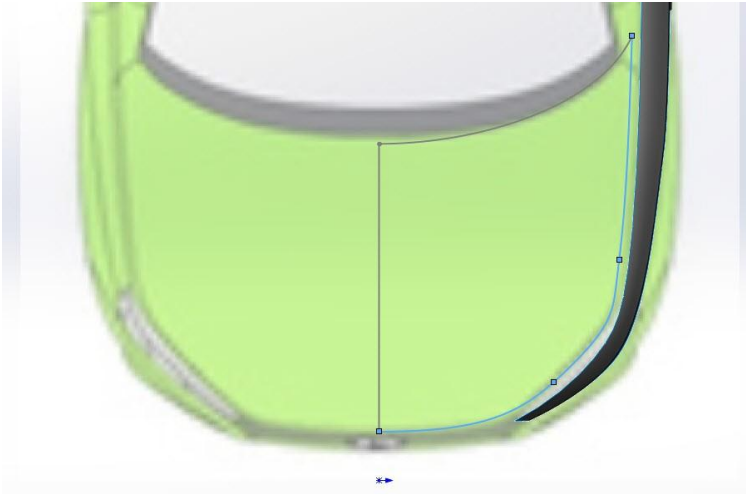
Рисунок 14.38 - Створюємо сплайн що позначає контур капота
