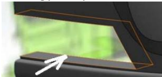
Рисунок 14.94 - Використання інструменту «Вытянуть поверхность»
