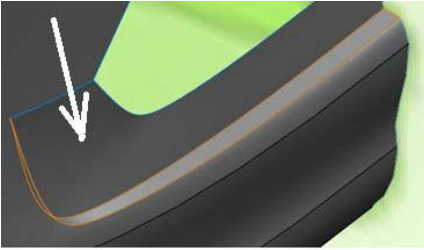
Рисунок 14.86 - Використання інструменту «Поверхність границь»
