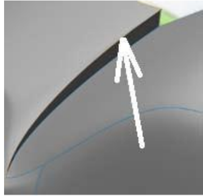
Рисунок 14.77 - Простір між капотом і лобовим склом
