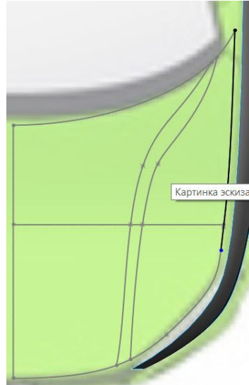
Рисунок 14.43 - Відтинаємо непотрібну частину
