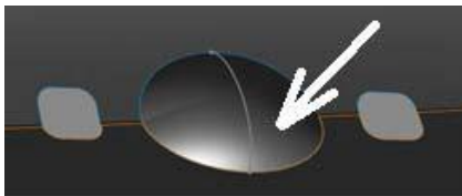
Рисунок 14.124 - Використовуємо інструмент «Поверхность заполнить»
