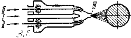
Рис. 7.7. Схема електродугової металізації:
